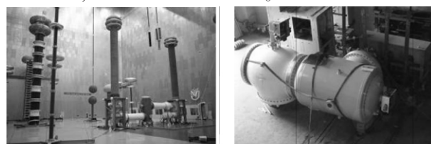
带电阻隔离开关绝缘、 开合小电流试验
