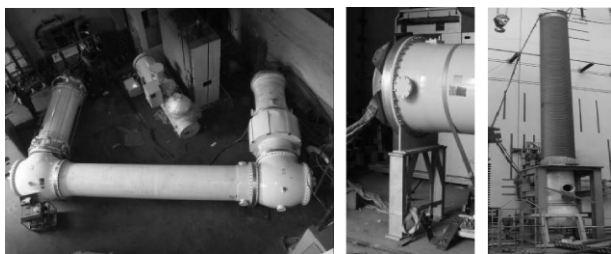
图 11 母线、电流互感器、接地回路、套管的短时、峰值耐受电流试验照片
